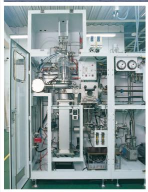
SV シリーズは、優れたシミュレーション技術と長年の経験から最適 設計された縦型石英リアクタを採用しています。GaAs 系・InP 系材 料において 30 年以上の歴史があるベストセラー機です。単枚機で あるため、均一性・再現性・急峻性が優れており、多数枚では実現 できない特性を有しています。
