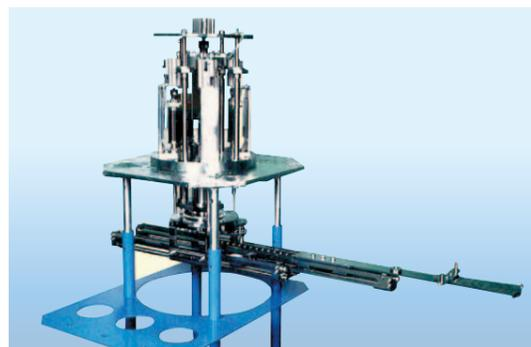
当社の長年のノウハウによる超高真空用アーム搬送システム。超高真空中で回転伸縮可能な3段アームが360°方向に試料を搬送します。量産機での採用をはじめ、研究室でも多くの実績があります。
